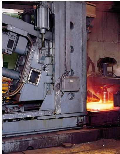
Bild 3: Ringwalzvorgang auf einer Radial-Axial-Ringwalzmaschine; gleichzeitig werden Ringhöhe und Ringwanddicke in zwei Walzspalten reduziert.
